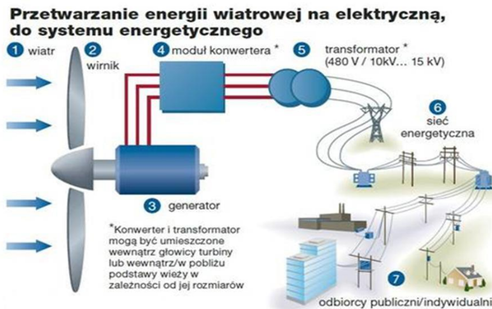
Rys.9. Schemat przetwarzania energii wiatrowej na elektryczną
